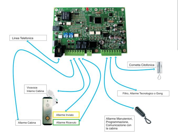
Applicazione Alimentazione Assorbimento massimo (@12 Vdc) Assorbimento minimo (@12 Vdc) Corrente max contatti relè Dimensioni Peso Sala macchine, fissaggio a parete, tetto cabina 10 ÷ 16 Vdc 240 mA 30 mA 3A @ 120 Vac / 3A @ 24 Vdc 167 x 107 x 28 mm 275 g
